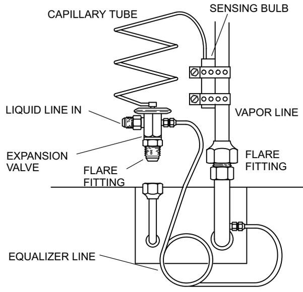
**RFCIII REFRIGERANT FLOW CONTROL DEVICE**
