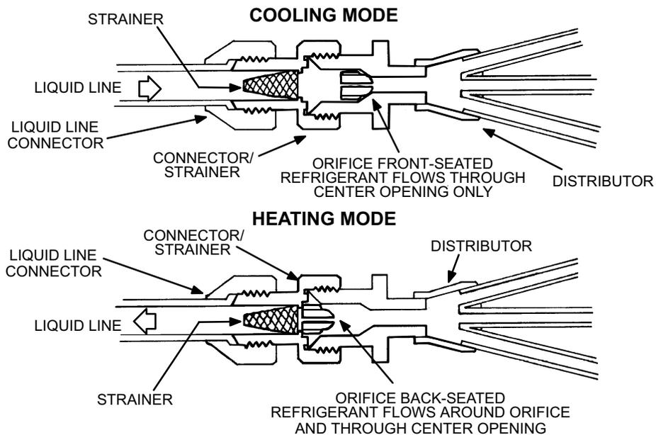
**Figure 25. Metering Devices**
