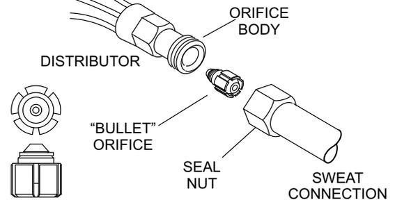
**RFCIII REFRIGERANT FLOW CONTROL DEVICE**
