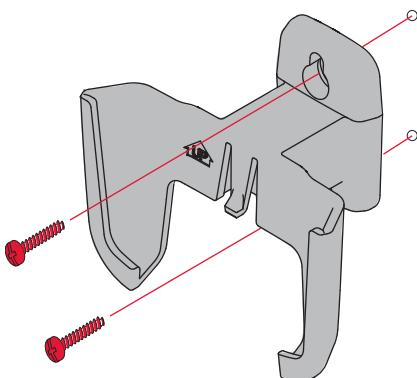
Installer le capteur sur un mur extérieur à la verticale, à au moins 6 pouces (15 cm) de tout surplomb. Choisir un emplacement où le capteur sera à l'abri des rayons du soleil.
