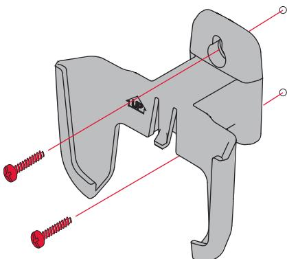
Instale el sensor en una pared exterior vertical, a 6 pulgadas (15,2 cm) como mínimo, debajo de cualquier alero. Elija una ubicación donde no haya luz solar directa.
